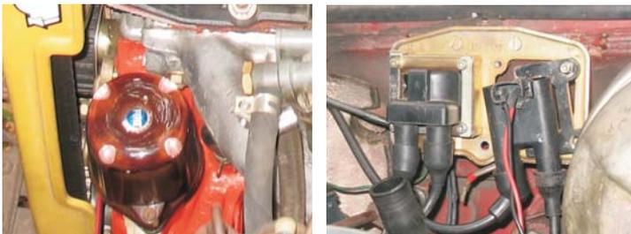
El hecho de recortar el distribuidor, facilita la instalación de múltiples y carburadores dobles, ya que si no se hace esto, los cables y las torres de salida interfieren con el múltiple especial.
