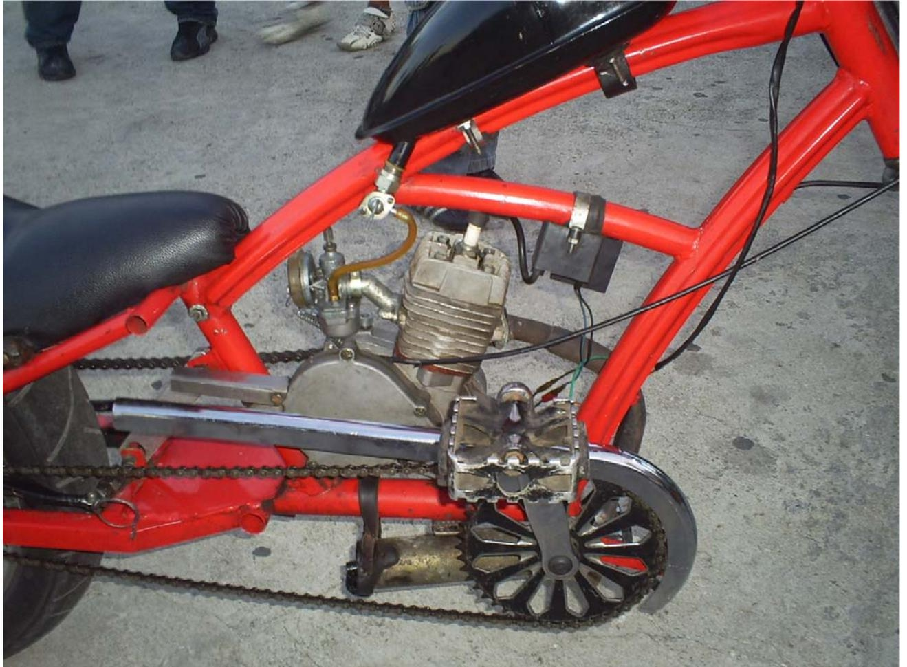
En el 2011, prolongó el tenedor (horquilla) y le hizo algunas mejoras al sistema de encendido electrónico, colocando un fan de enfriamiento forzado en la caja reguladora para garantizar una temperatura adecuada en la circuitería, tanque de combustible más grande para mejorar su autonomía y, producto de la velocidad desarrollada por el motociclo, fue necesario colocar un sistema de freno disco -en la rueda delantera- para incrementar el frenado en la carretera.
